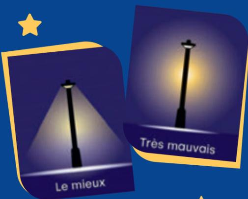
Depuis 2018, la réglementation interdit l'installation de luminaires qui émettent plus de 4% de lumière au-dessus de l'horizontal.
