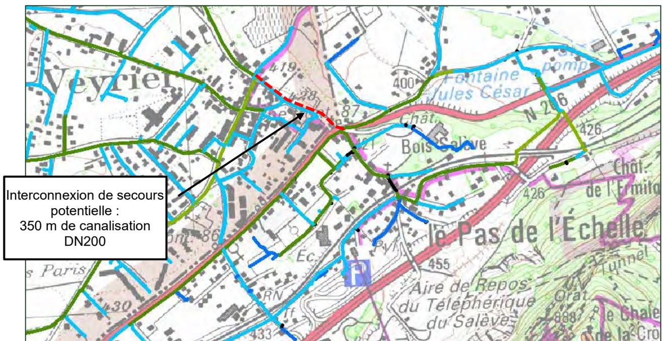
Le niveau piézométrique maximal du réseau de Veyrier est de l'ordre de 490 m soit une pression maximale appliquée de l'ordre de 7 bars au niveau du point d'interconnexion potentiel.
